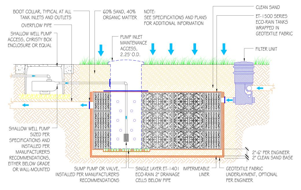
ECORAIN TANK WATER HARVEST STRUCTURE SUMP PUMP OR EXTERIOR PUMP SECTION
